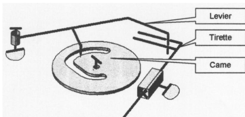
Trois cames montées sur le même axe et solidaires d'une roue dentée entraînée par le pignon de sortie du réducteur agissent sur trois leviers. Chacun de ces leviers actionnant une tirette correspondant au mouvement souhaité.
