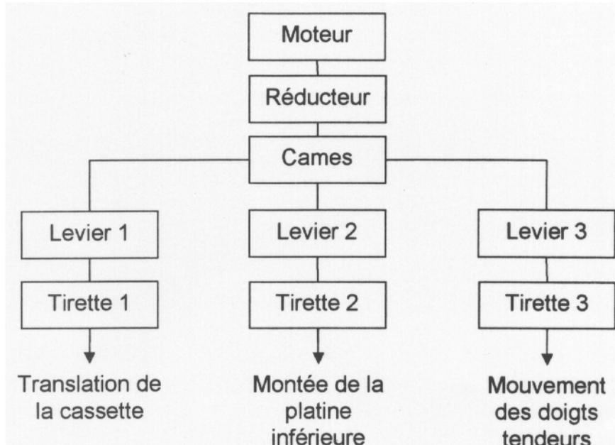
Le système « cames + leviers » est donc au coeur du mécanisme et on se propose d'en prévoir l'organisation.
