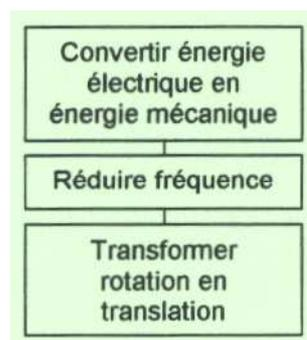
Pour réduire les coûts et gagner de la place on envisage d'utiliser le même moteur et le même réducteur pour les trois mouvements. Ce qui conduira au diagramme suivant :
